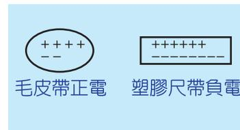
圖 1-2b 摩擦後電子跑到塑膠尺
